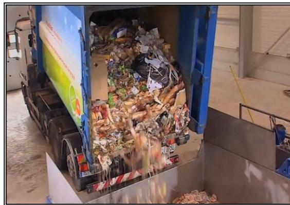
Déchargement des biodéchets dans la trémie mobile
