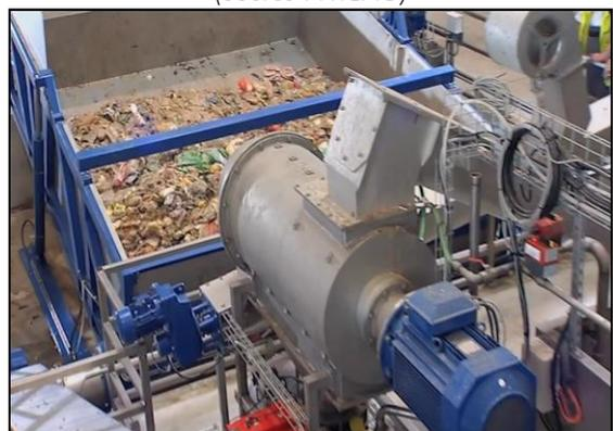
Système de broyage/criblage des biodéchets
