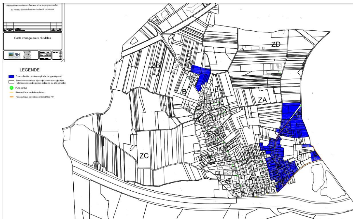
Figure 30 : Zonage eaux pluviales
